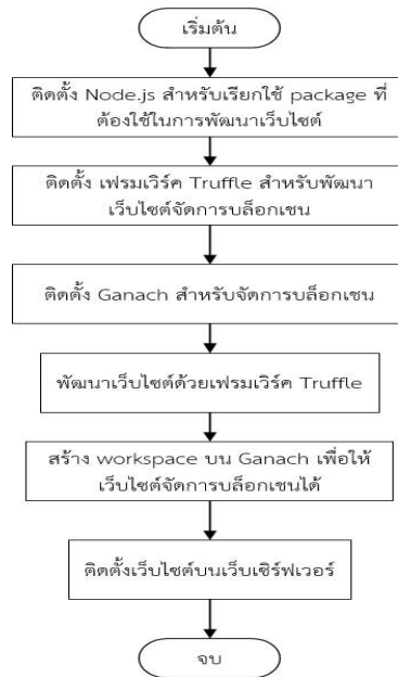
ภาพที่ 5 flowchart ขั้นตอนแปลงข้อมูลเข้าสู่บล็อกเชนที่ใช้แพลตฟอร์มอีเธอเลียม
