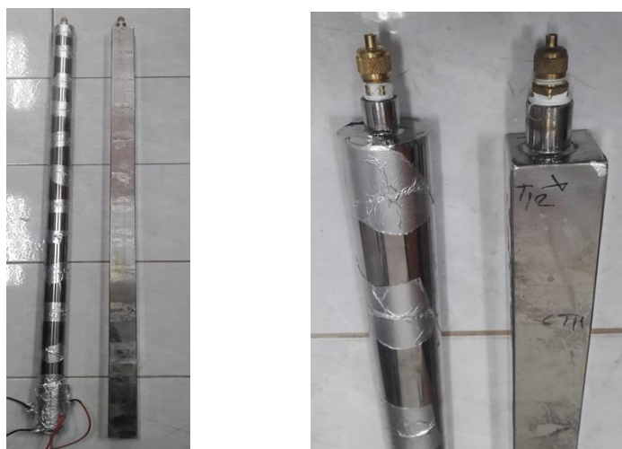
(ก) ลักษณะของเทอร์โมไคฟอนที่ใช้ในการทดลอง (ข) ภาพหน้าตัดเทอร์โมไคฟอนทั้งสองแบบ
