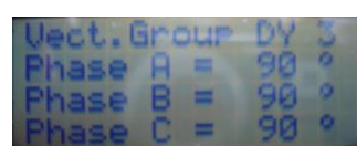
ภาพที่ 17 ค่าองศาเป็นไปตาม Phase Displacement Group
