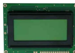
ภาพที่ 9 LCD แบบ 4 บรรทัด 16 ตัวอักษร
