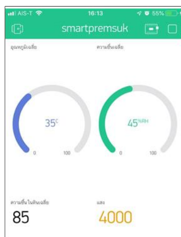
ภาพที่ 10 แอปพลิเคชัน บลิงค์ (Blynk) เพื่อใช้ตรวจสอบสภาพแวดล้อมภายในโรงเรือนจากอินเทอร์เน็ต
