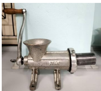
(ก) ลักษณะส่วนประกอบของเครื่องอัดถ่านแบบมือหมุน
