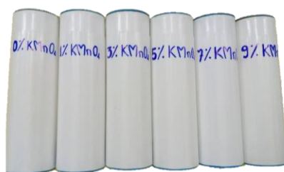
ภาพที่ 1 สารกรองที่บรรจุลงในท่อกรองที่ความเข้มข้นต่าง ๆ ของ \text{KMnO}_4
