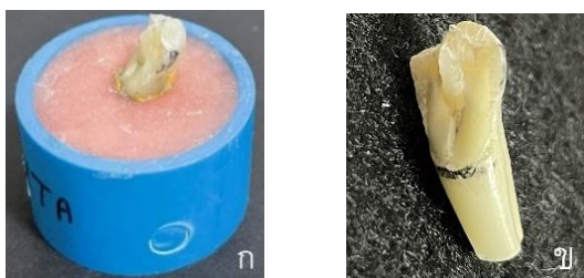
ภาพที่ 4 การแตกหักซึ่งเกิดที่ระดับระดับต่ำกว่าระดับรอยต่อระหว่างเคลือบฟันกับเคลือบรากฟัน 2 มิลลิเมตร ก. ภาพชิ้นงานหลังการทดสอบในบลิออคอะคริลิกเรซิน ข. ฟันซึ่งเกิดการแตกหักหลังการทดสอบ
