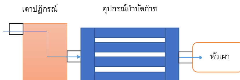
ภาพที่ 10 ลักษณะการทำงานของเตาปฏิกรณ์แก๊สซิฟิเคชันร่วมกับอุปกรณ์บำบัดก๊าซและหัวเผา
