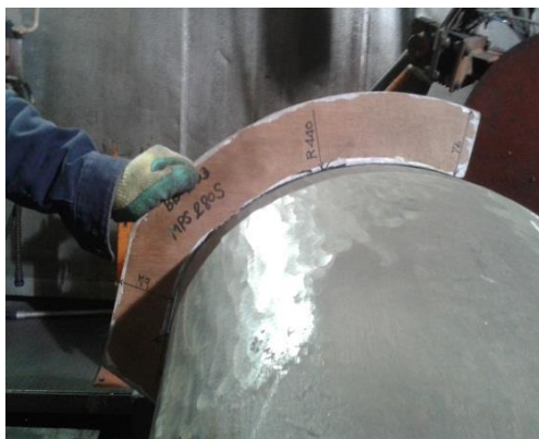
ภาพที่ 6 โรลเลอร์โมโนบล็อก MPS 280 แสดงการตรวจสอบการเจียรออก
