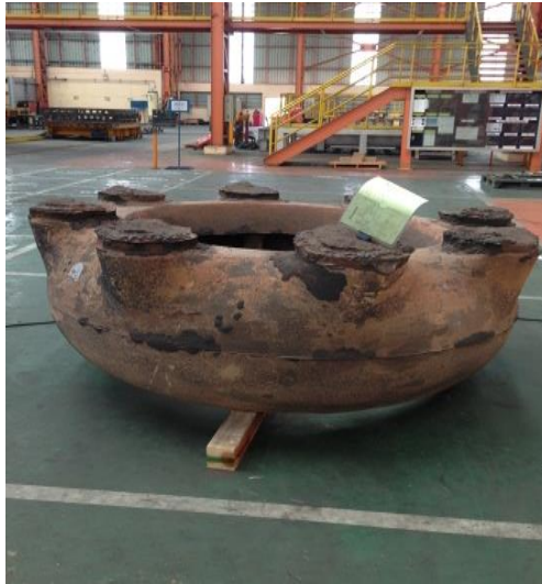
ภาพที่ 3 โรลเลอร์โมโนบล็อก MPS 280 ก่อนเจียร
