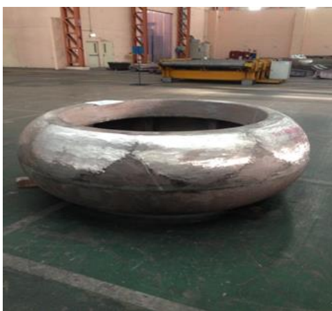
ภาพที่ 7 โรลเลอร์โมโนบล็อก MPS 280 หลังเจียรเสร็จทั้งลูก
