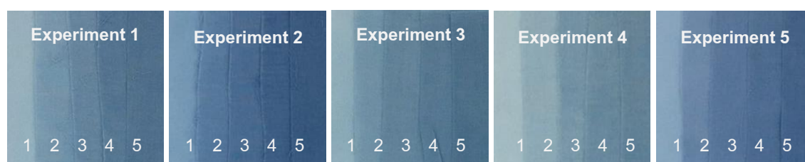
ภาพที่ 7 ผ้าฝ้ายที่ย้อมด้วยสีที่สกัดจากผงใบครามแห้งจากต้นครามพันธุ์ Indigofera tinctoria โดยใช้จำนวนครั้งในการย้อมทับแตกต่างกัน ครั้งที่ 1 2 3 4 และ 5
