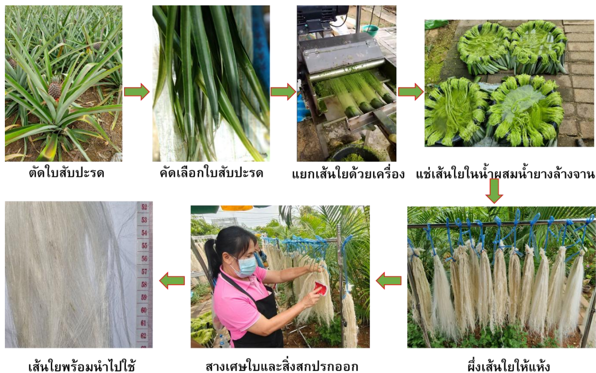
ภาพที่ 1 ขั้นตอนการผลิตเส้นใยสับปะรด
