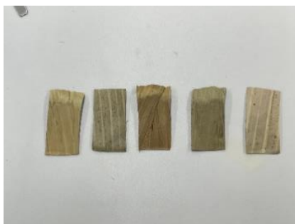
ภาพที่ 4 การเตรียมตัวอย่างสำหรับการทดสอบการซึมผ่านของน้ำ
