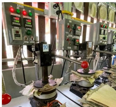
ภาพที่ 1 ขั้นตอนการขึ้นรูปภาชนะจากใบตอง
