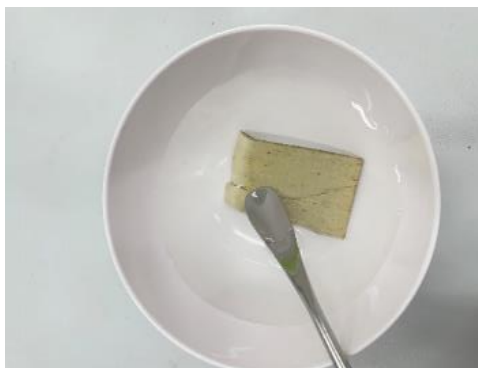
ภาพที่ 5 การทดสอบการซึมผ่านของน้ำของภาชนะขึ้นรูปจากใบตองตากแดด
