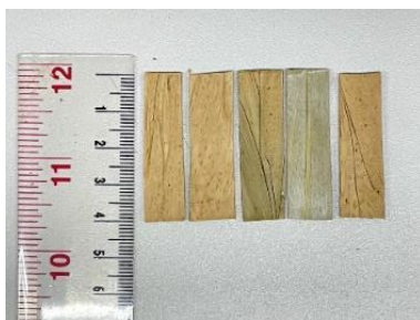
ภาพที่ 3 การเตรียมตัวอย่างสำหรับการทดสอบแรงดึง
