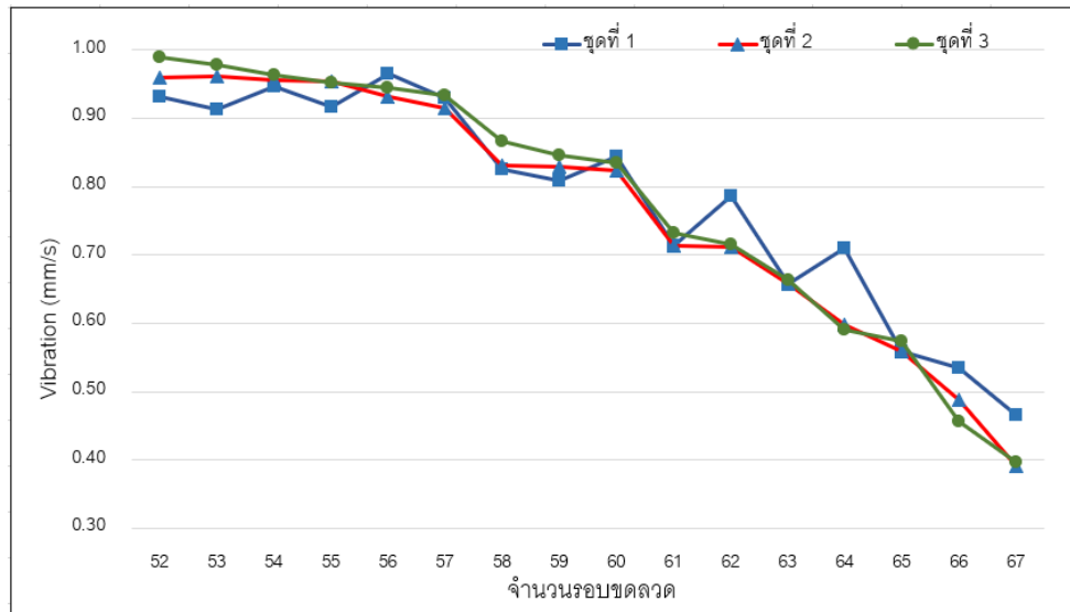
ภาพที่ 7 จำนวนรอบขดลวดกับการสั่นสะเทือนของหม้อแปลงที่ความถี่ 200 Hz ทั้ง 3 จุด
