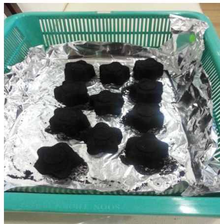
ภาพที่ 2 ขั้นตอนการทำแท่งเชื้อเพลิงจากกากกาแฟและกากชา
