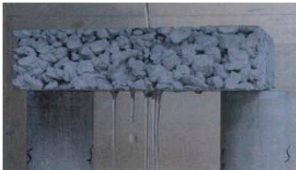
ภาพที่ 1 น้ำสามารถซึมผ่านคอนกรีตได้
