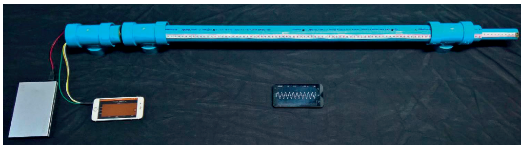
ภาพที่ 4 ชุดทดลองเรื่องการสั่นพ้องของเสียงโดยใช้สมาร์ทโฟนและท่อพอลิไวนิลคลอไรด์ (PVC)
