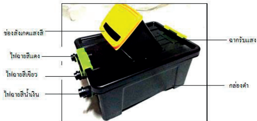
ภาพที่ 4 ชุดทดลองเรื่องการผสมแสงสี
