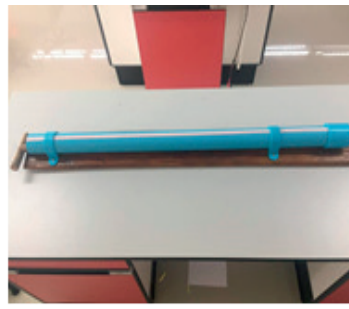
ภาพที่ 5 ชุดการทดลองคลื่นนิ่ง
