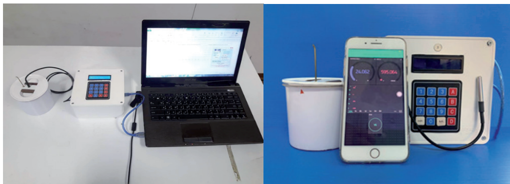
ภาพที่ 4 ตรวจวัดค่าความร้อนของปฏิกิริยาด้วยแคลอรีมิเตอร์ชุดพัฒนาที่มีการแสดงผลอัตโนมัติบนคอมพิวเตอร์ และแสดงผลผ่าน IoT ด้วยแอปพลิเคชัน Blynk บนสมาร์ตโฟน
