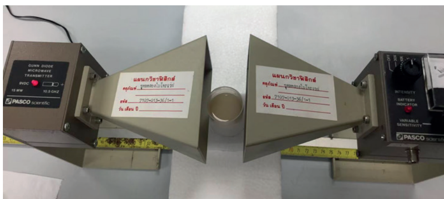
ภาพที่ 1 มุมบนของเครื่องมือ Microwave Optics
