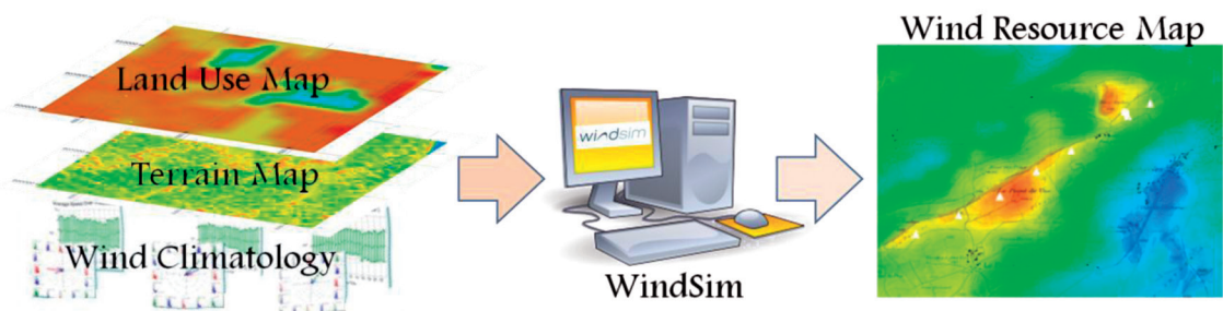
ภาพที่ 2 ขั้นตอนของการประเมินศักยภาพพลังงานลมด้วยแบบจำลองพลศาสตร์ของไหลเชิงคำนวณ
