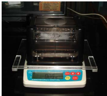
ภาพที่ 1 B เครื่องหาความหนาแน่นระบบไฟฟ้า (Electronic Densitymeter)
