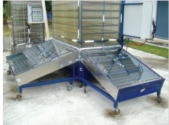
รูปที่ 1 แสดงเครื่องอบแห้งปลาพลังงานร่วมแสงอาทิตย์-ไฟฟ้า ที่มีแผงรับรังสีอาทิตย์ทั้ง 3 ด้านของเครื่องอบ
