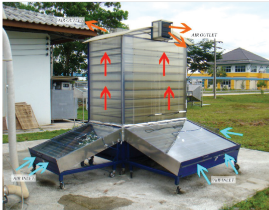
รูปที่ 1 แสดงเครื่องอบแห้งปลาพลังงานร่วมแสงอาทิตย์-ไฟฟ้า ที่มีแผงรับรังสีอาทิตย์ทั้ง 3 ด้านของเครื่องอบ
