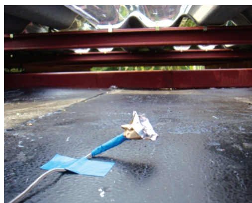
(ข) แสดงจุดวัดอุณหภูมิใต้หลังคา
