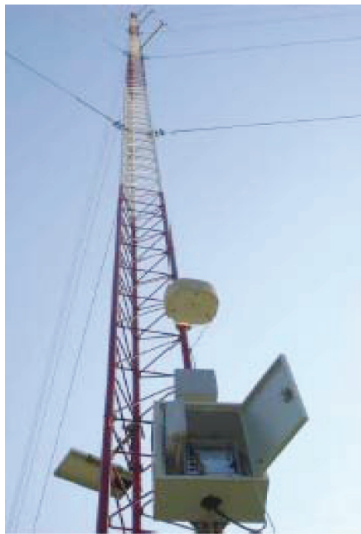
รูปที่ 2 เซนเซอร์วัดอัตราเร็วและทิศทาง อุณหภูมิอากาศ เซลล์แสงอาทิตย์ประเภทเตอร์รีและอุปกรณ์บันทึกข้อมูลอัตโนมัติ
