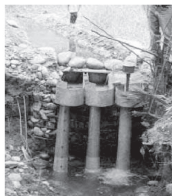
รูปที่ 2 กังหันน้ำแบบคอยาวขนาด 200 W สำหรับครัวเรือนที่ติดตั้งในประเทศเอกวาดอร์ [2]
