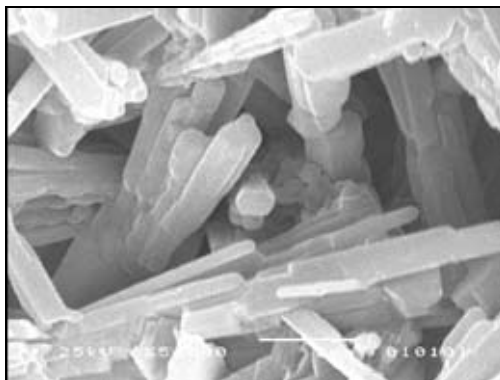
ภาพที่ 2 โครงสร้างจุลภาคของปูนพลาสติก ถ่ายด้วยกล้องจุลทรรศน์อิเล็กตรอนชนิดส่องกราด (JSM-5200, JEOL, Japan) กำลังขยาย 5,000 เท่า
