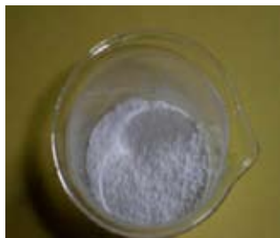
ภาพที่ 4 ตัวเร่งปฏิกิริยาซีโอไลต์ NaY/KOH
