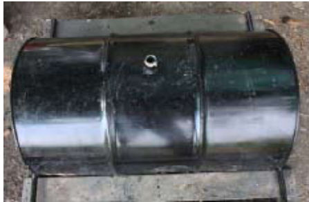
ภาพที่ 1 ถังเก็บก๊าซจากโคลน
