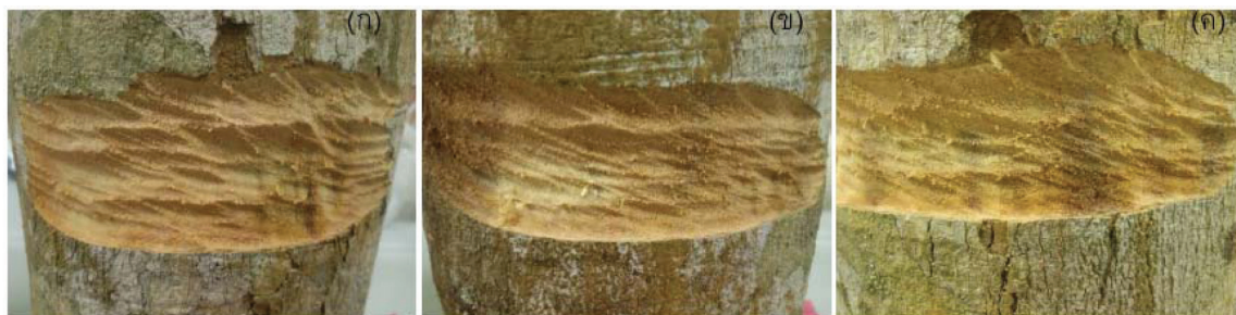
ภาพที่ 7 ลักษณะของหน้ายางจากการกรีดด้วยมีดกรีดยางวงกลมแบบที่ 3 ด้วยความเร็ว (ก) 1,000 รอบต่อนาที (ข) 1,250 รอบต่อนาที และ (ค) 1,500 รอบต่อนาที
