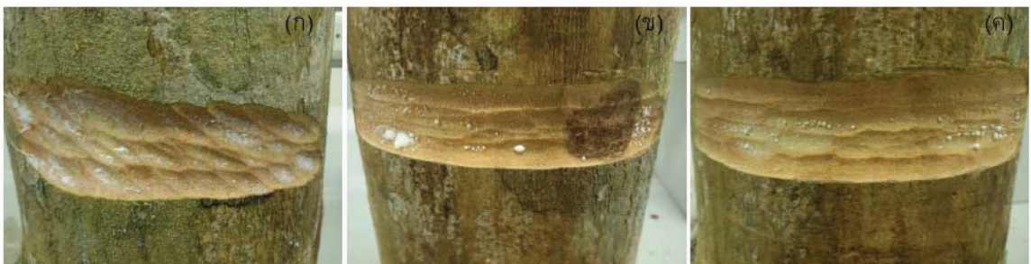
ภาพที่ 5 ลักษณะของหน้ายางจากการกรีดด้วยมีดกรีดยางวงกลมแบบที่ 1 ด้วยความเร็ว (ก) 1,000 รอบต่อนาที (ข) 1,250 รอบต่อนาที และ (ค) 1,500 รอบต่อนาที
