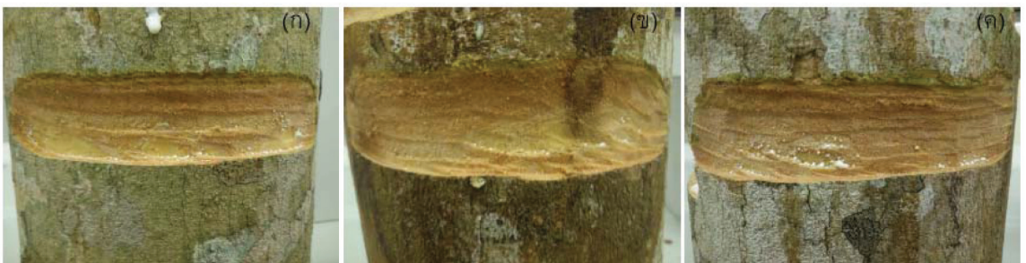
ภาพที่ 6 ลักษณะของหน้ายางจากการกรีดด้วยมีดกรีดยางวงกลมแบบที่ 2 ด้วยความเร็ว (ก) 1,000 รอบต่อนาที (ข) 1,250 รอบต่อนาที และ (ค) 1,500 รอบต่อนาที
