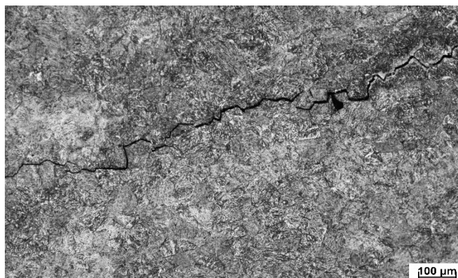
ภาพที่ 4 โครงสร้างจุลภาคของกระบวนการชุบแข็งเปลวไฟที่อุณหภูมิผิวสูงสุด 876 องศาเซลเซียส
