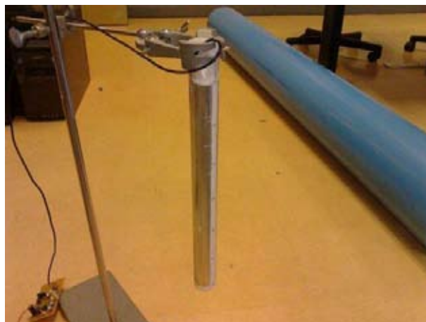
ภาพที่ 1 รูปแบบของหัววัดความจุไฟฟ้าแบบกึ่งทรงกระบอก
