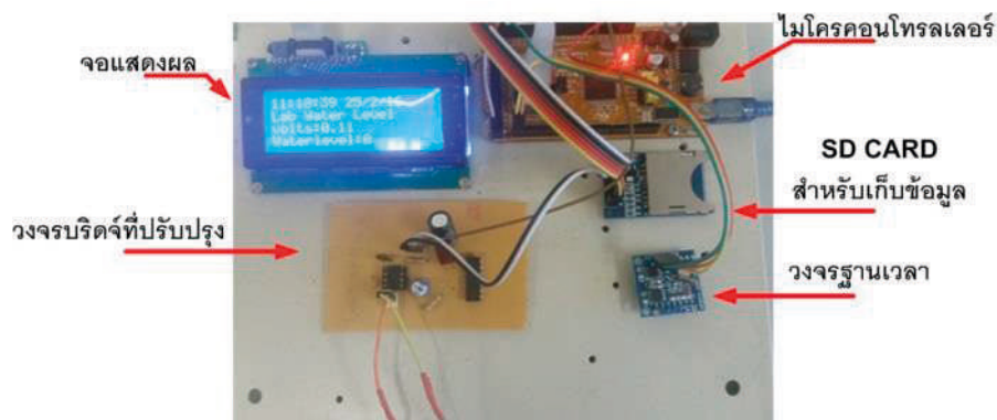
ภาพที่ 7 องค์ประกอบของเครื่องวัดระดับน้ำที่ใช้ในการทดลอง
