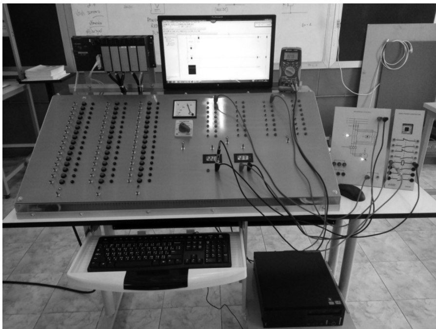
ภาพที่ 3 ชุดทดลองการควบคุมมอเตอร์ไฟฟ้า ด้วย Programmable Logic Controller ที่สร้างและพัฒนาขึ้น
